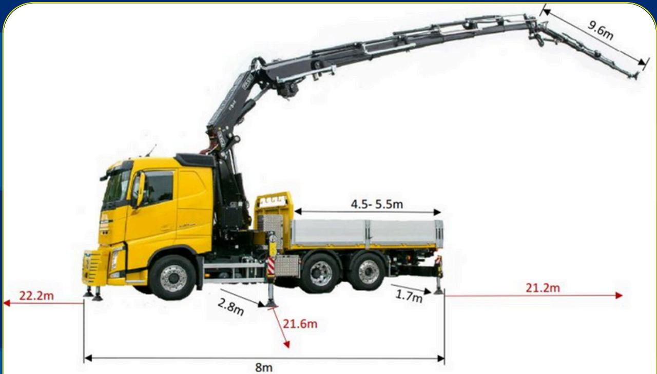
Rot: Kran max ausgefahren ab Stützen
